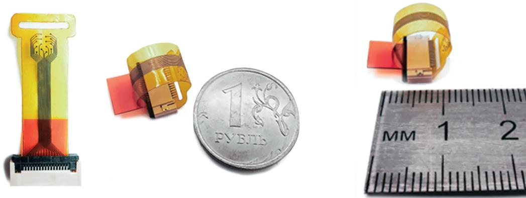
Рисунок 10. Фото полученного прототипа тонкопленочного электрода.
